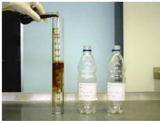
3. أضف بعض الماء إلى الوعاء المحتوي على عينة الاختبار. قم بخضّ العينة بشكل جيد، وأضفها إلى وعاء المحلول الأصلي. كرّر هذه العملية مرتين للتأكد أن كل مواد الاختبار قد تم إزالتها من العبوة الأصلية.
